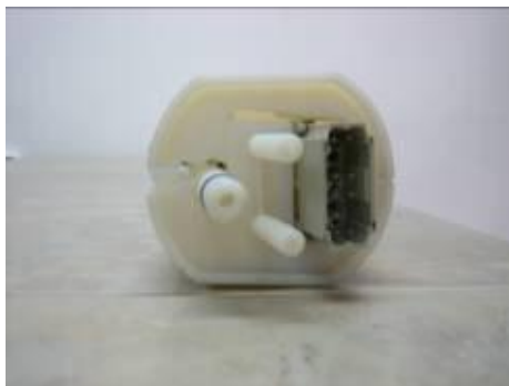
Рис. 4-6. Двойное соединительное звено для электрической и вакуумной розеток
