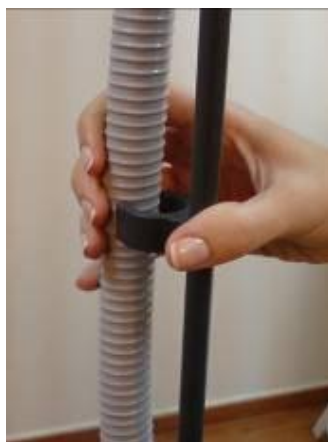
Рис. 4-5. Установка шланга в петли держателя
