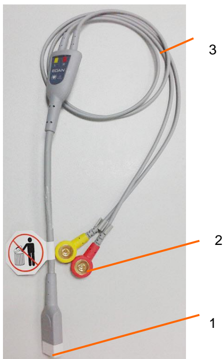
Рис. 2-9. Кабель ЭКГМ на 2 отведения
