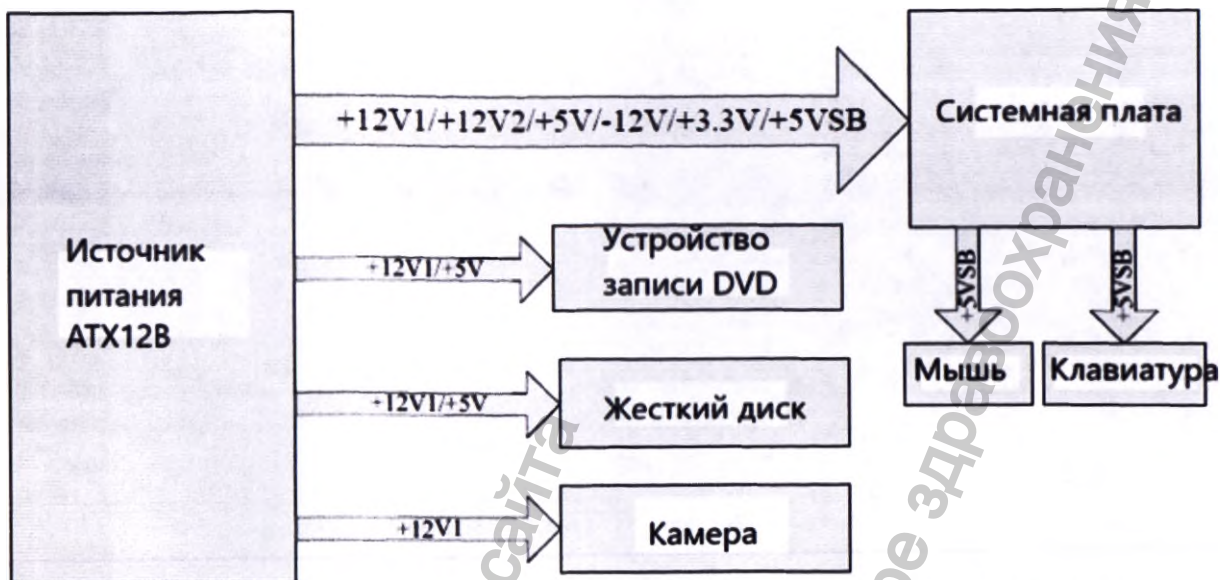
Рисунок 5.35. Блок-схема системы питания внутри главной системы
